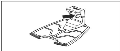
2. Vérifiez si les raccordements du câble périphérique à la station de charge sont correctement effectués et non endommagés. Vérifiez si le voyant de la station de charge clignote toujours en bleu.
