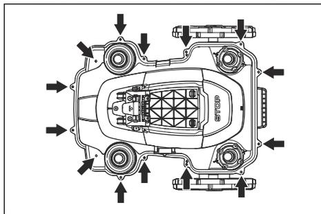
5. Soulevez le bord arrière de la section supérieure du châssis.
