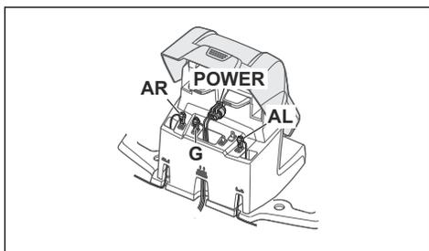
3. Permutez les raccordements entre le câble guide et le câble périphérique de la station de charge.
