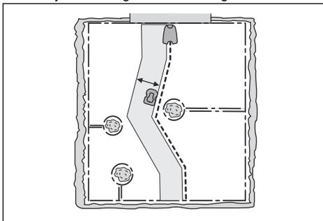
La largeur de couloir est ajustée automatiquement. S'il est nécessaire de régler manuellement la largeur du couloir afin que le produit fonctionne correctement, vous pouvez la régler entre 0-9. Si la largeur du couloir guide est réglée sur 0, le produit chevauche le câble guide. Le réglage d'usine est de 6 pour le câble périphérique et de 9 pour le câble guide.
