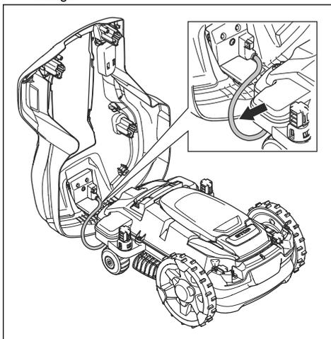
**Remarque:** Assurez-vous que les passe-câbles du câble de charge sont correctement installés pour assurer l'étanchéité contre l'humidité une fois le corps du produit retiré.
