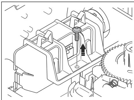
7. Poussez pour détacher les attaches et soulevez le support de batterie.
