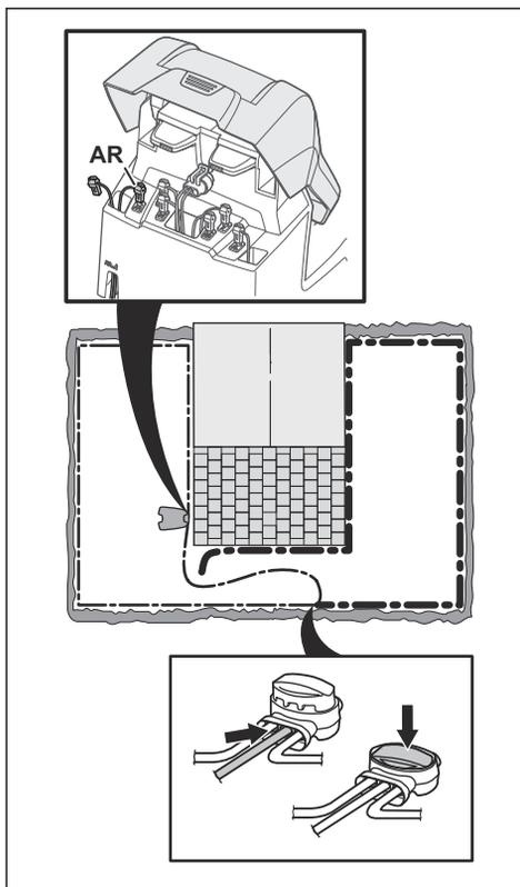
Si le voyant est maintenant vert, cela signifie que la coupure se trouve quelque part entre l'extrémité débranchée et l'endroit où le nouveau câble est branché (ligne noire épaisse sur l'illustration). Dans ce cas, déplacez la connexion destinée au nouveau câble plus près de l'extrémité débranchée (en gros, au milieu de la partie du câble suspectée) puis vérifiez de nouveau que le voyant est vert.
