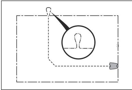
**Remarque:** Faites un plan de la zone de travail avant d'installer le câble périphérique et le câble guide.
