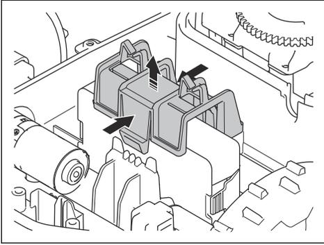
8. Débranchez le câble de batterie du panneau de commande du circuit principal.
