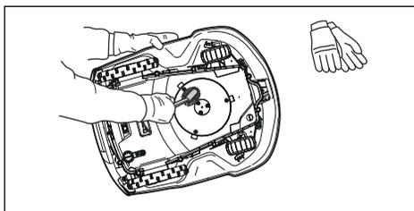
9. Pour installer le corps du produit, placez-le sur le châssis et poussez-le en position.
